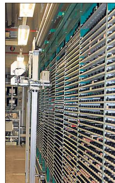
80 Prozent der Waren werden von einem Kommissionier-Automaten sortiert. Er schiebt die einzelne Medikamentenpackung an, so dass sie auf der anderen Seite in eine Versandbox fällt.
